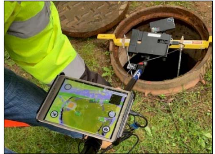
DPI延長ポール取付キットに装着した状態のDPI-8S SR
